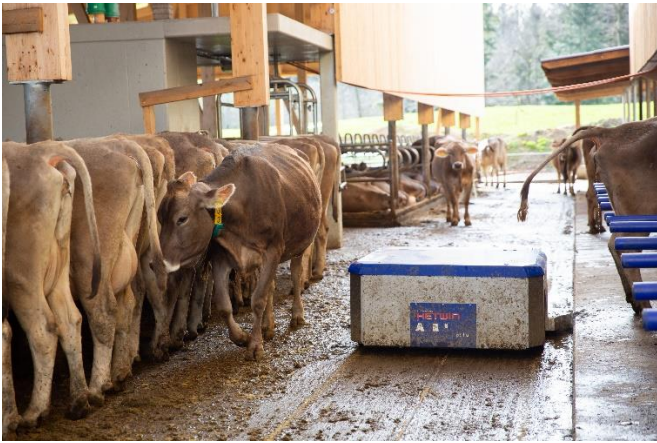
Mobile Entmistung der Laufflächen mit Quergefälle und Harnsammelrinne an der Seite, (rechts), Musterbetrieb Zimmermann (R1), Küssnacht SZ. Bild: M. Wittwer
